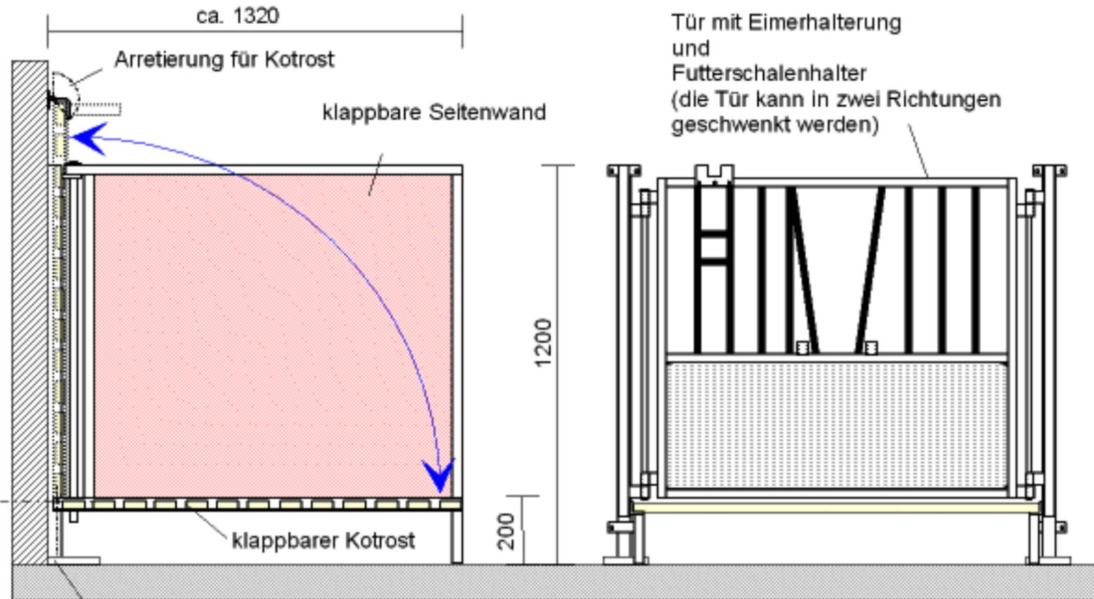
Standsäule mit Scharnier am Mauerwerk angedübelt
